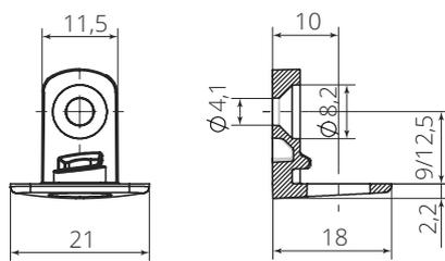
Кронштейн для установки полки с отверстием для закручивания шурупа заподлицо. Для использования с полкодержателем **GN301** или **GN331**. Крепление на еврвинт.
