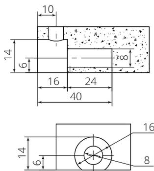
Полкодержатель диаметром 16 мм со встроенным механизмом фиксации. Максимальный вес полки 40 кг, максимальная горизонтальная сила 60 кг. Изготовлен из замака и пластика. Для использования с кронштейном **GN301FP**.
