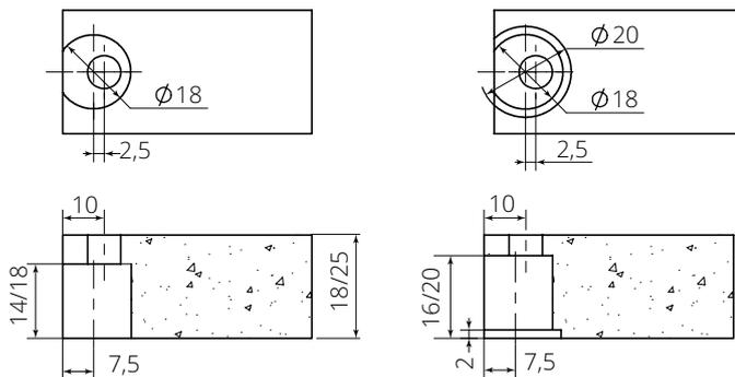
Полкодержатель со встроенным механизмом фиксации. Максимальный вес полки толщиной 18 мм 40 кг, толщиной 25 мм – 50 кг. Для использования с кронштейном **GN301FP**.
