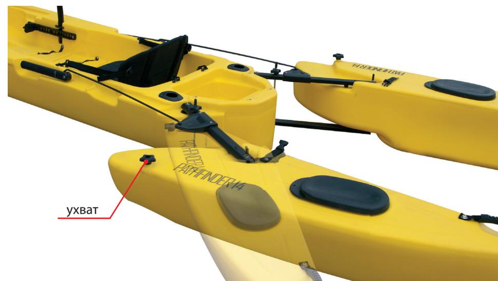
Для возврата аутригеров в закрытое положение потяните за звездообразные ухваты и верните аутригеры в положение «Y». Переведите рычаги в положение «назад» и зафиксируйте аутригеры в закрытом положении.
