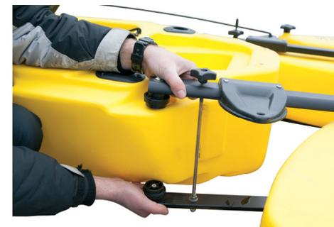
Верните крепежный винт на посадочное место, закрутите так, чтобы он не потерялся. Аутригер готов к транспортировке.
