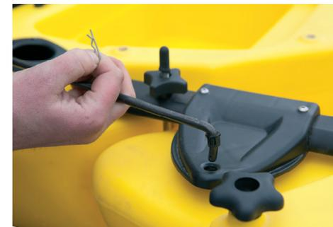
Отвинтите винт, фиксирующий держатели аутригера (струбины).
