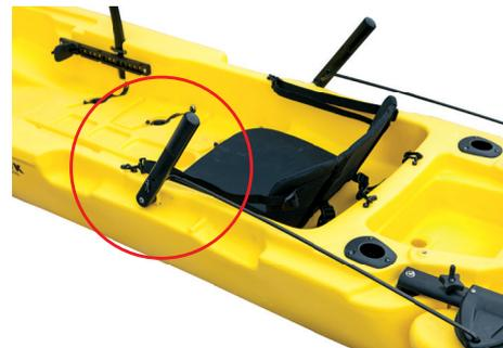
Выньте втулку, фиксирующую привод, отсоедините привод.
