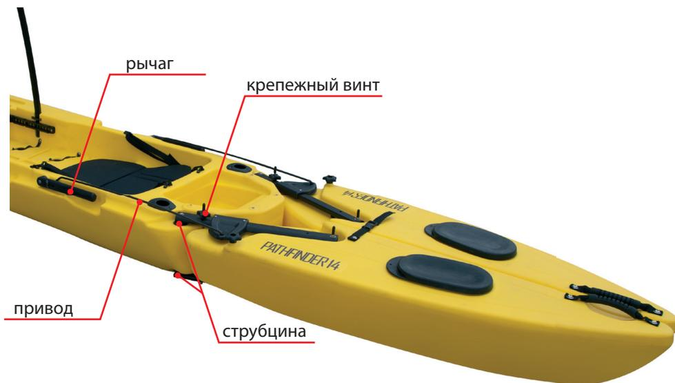
Слегка приподнимите рычаг, чтобы ослабить натяжение привода.
