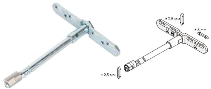
Полкодержатель скрытого монтажа для надежного крепления полок к стене. Фрезерная обработка полкодержателя предохраняет от проскальзывания внутри полки. Регулировка в двух направлениях.
